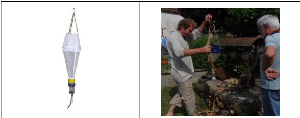
Filet Cvetkov ou phréatobiologique : détail et maniement in situ
