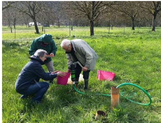
Appareillage pour pompage en piézomètre : détail et fonctionnement in situ
