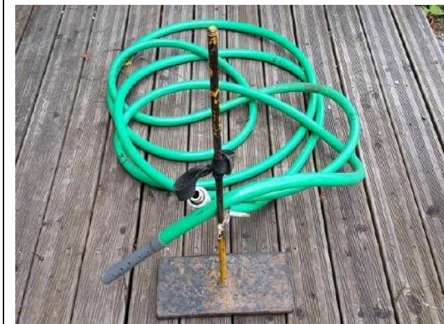
Appareillage pour pompage en piézomètre : détail et fonctionnement in situ
