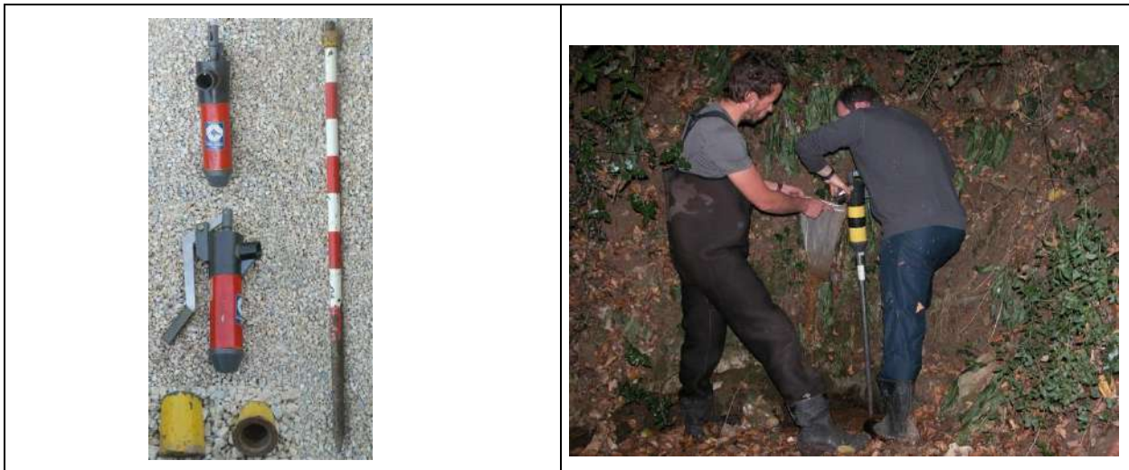
Pompe Bou-Rouch : détail et maniement in situ
