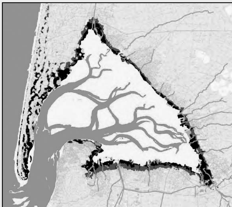
Figure 4 : Les zones basses inondables autour du Bassin d'Arcachon (en noir, les niveaux de 1,5 à 3,5 m NGF et, en gris foncé, de 3,5 à 4,5 m NGF) Source : SCOT, Etat initial de l'environnement, p. 243)
